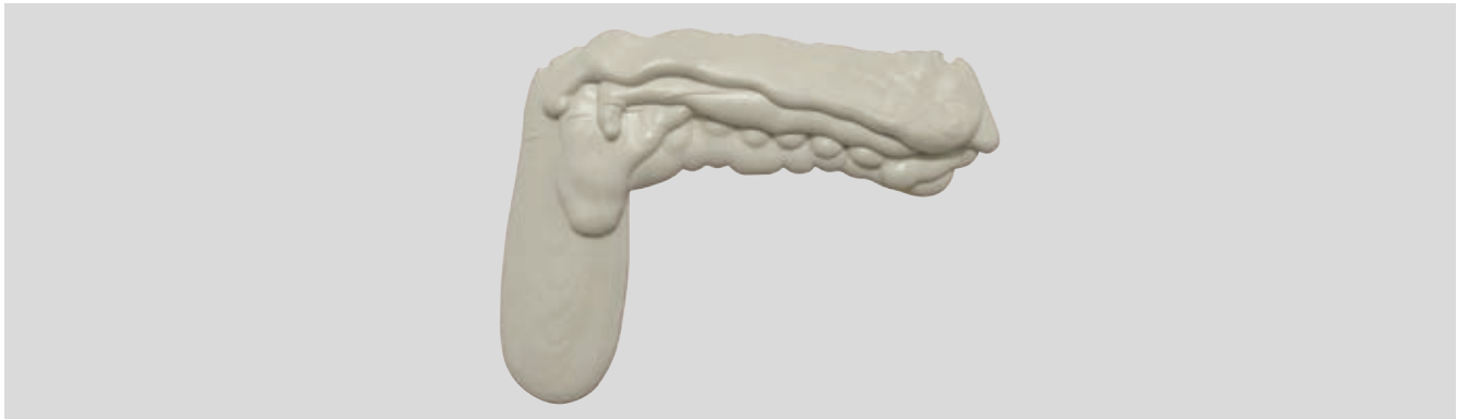
Typisches Verlaufs bild eines thixotropen Organomineralharzes
