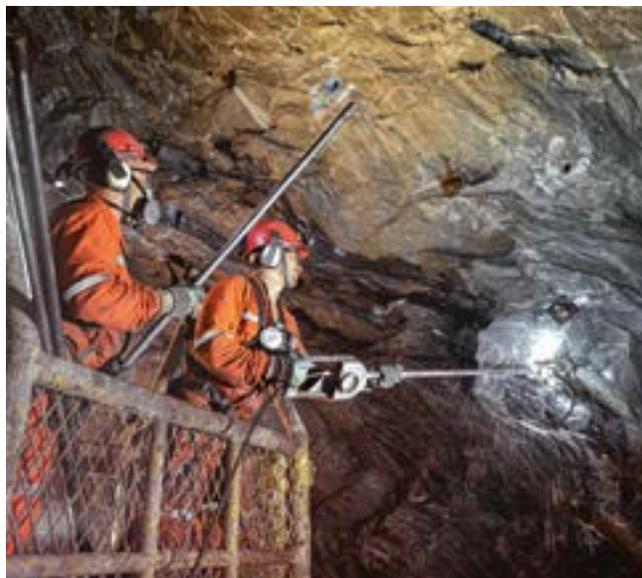
2. Connexion au mandrin d'installation et insertion de l'OMEGA-BOLT® dans le trou de forage.
