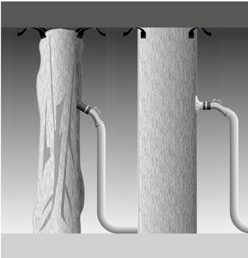
**Remarque :** pendant le remplissage (injection de ciment), tous les équipements de protection individuelle standard et recommandés doivent être utilisés. Les piliers BULLFLEX® sont résistants aux infiltrations d'eau de mine. Le tissu lui-même n'est soluble que dans les acides inorganiques concentrés et le phénol.
